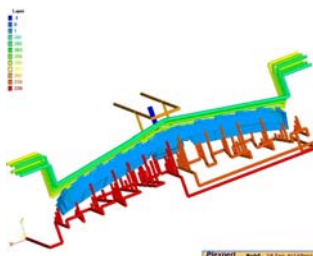
Thermische Auslegung des Werkzeuges
